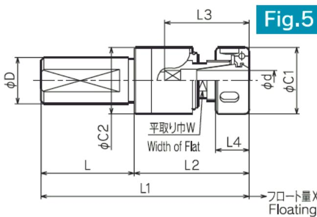
軸がフローとすることによりネジピッチ誤差を吸収する NC 旋盤用のタップホルダです。
